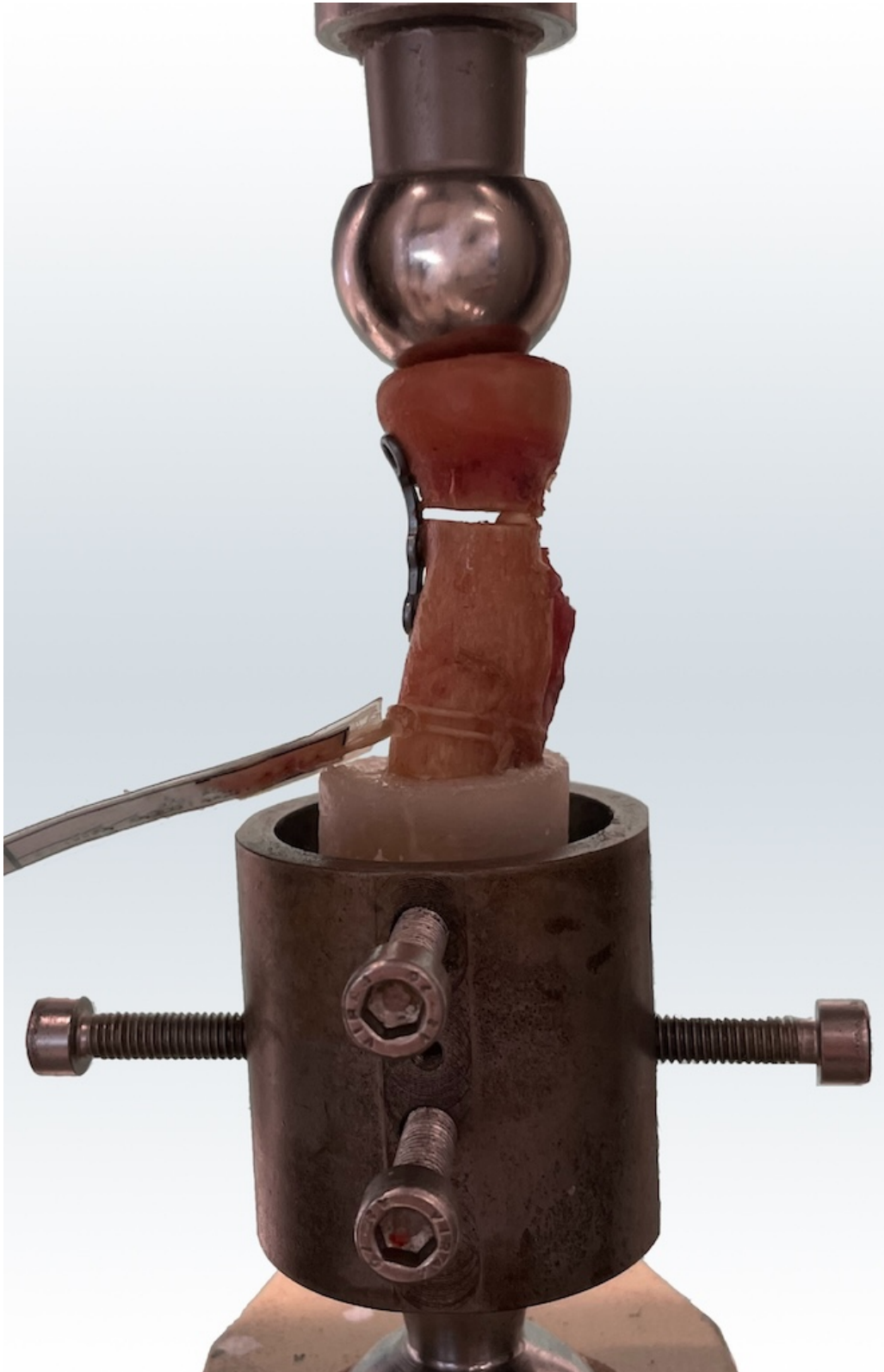
Abbildung 1: Versuchsaufbau eines proximalen Radius mit additiver Knochenspanaugmentation aus der ipsilateralen Ulna und osteosynthetischer Versorgung mittels Plattenosteosynthese (Aptus, Trilock 2.0 Abstütz Platte (A-4656.69) Fa. Medartis)
